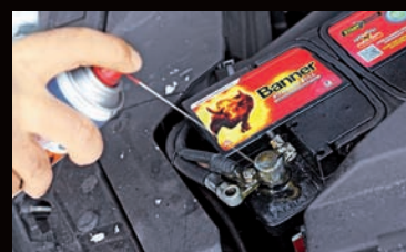
Svorkovnice udržujte čisté a ošetřete je proti korozi. Baterie navíc musí být uchycena pevně.
