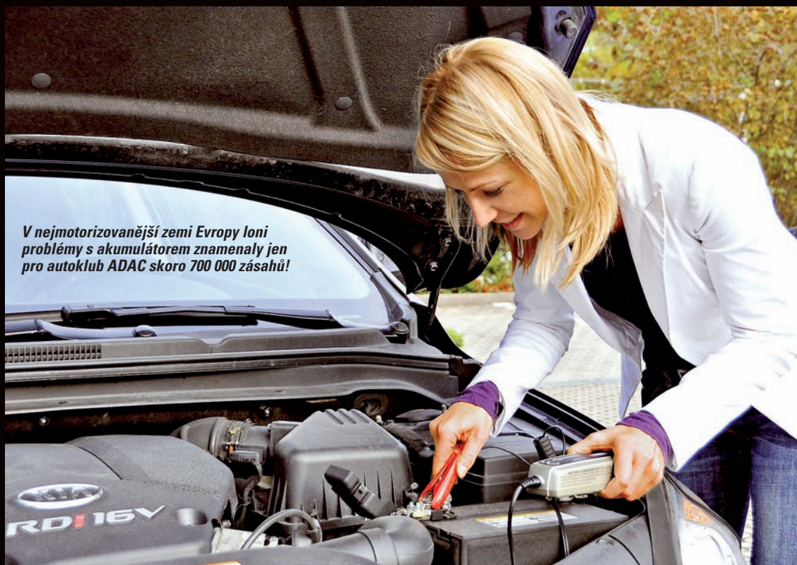
Svorkovnice udržujte čisté a ošetřete je proti korozi. Baterie navíc musí být uchycena pevně.
